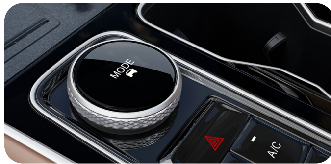
Интеллектуальный полный привод обеспечивает отклик муфты примерно за 0,1 секунды и непрерывную передачу крутящего момента на заднюю ось. В вашем распоряжении 7 режимов выбора движения — Нормальный, Экономичный, Спортивный, Песок, Грязь, Снег, Бездорожье.
