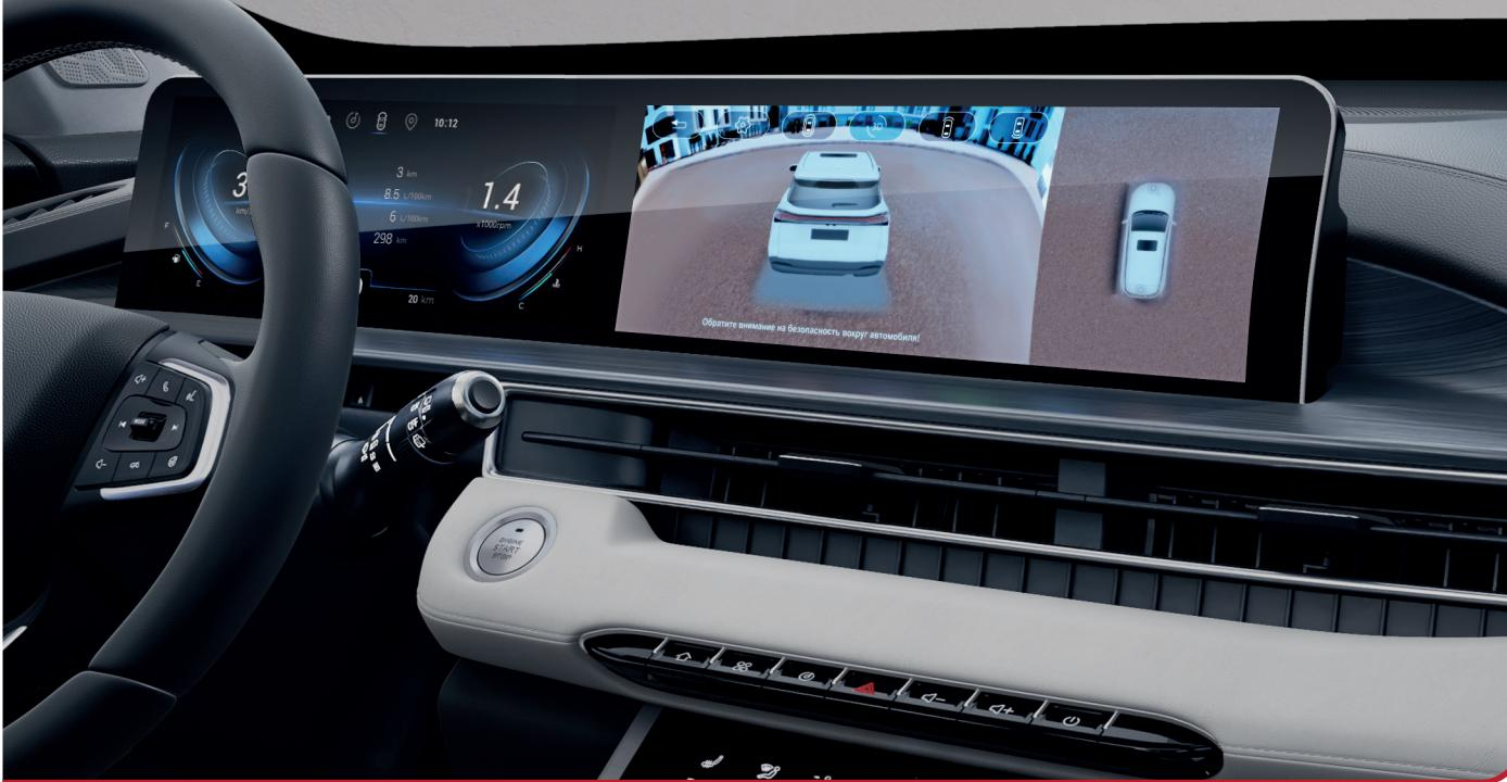
Каждый водитель Chery Tiggo 4 сливет мастером парковки! Ведь ему на помощь всегда приходит система камер кругового обзора и датчики парковки. Автомобиль отображается на экране дисплея в режиме дополненной реальности: 3D-ракурс, динамические линии траектории движения и указатели расстояния до препятствий.
